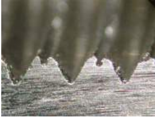
Sección de rosca obtenida por el macho de laminación en acero C45.
