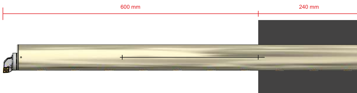
esempio di bloccaggio con barra D 60 mm - 10 x D example of holding method with D 60 mm - 10 x D bar
